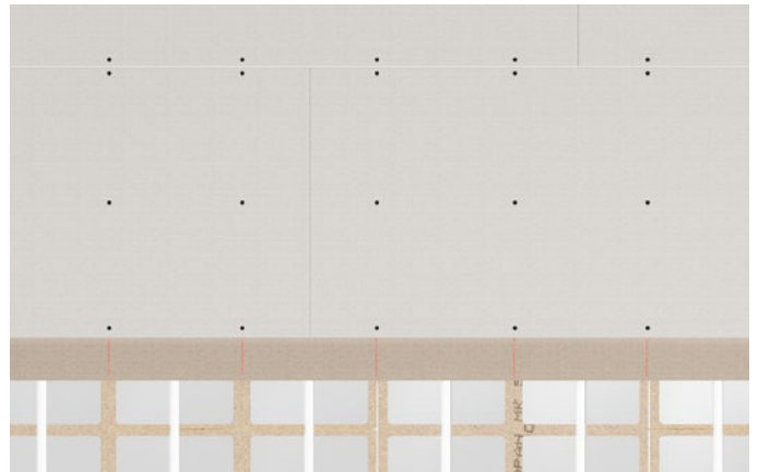
Figur 4 Mellemlagsplader af gulvgips eller fibergips på 22 og 25 mm Klimagulve monteres med skrueafstande efter de samme principper som vist på figur 2 og 3. Udførelse og skruedimensioner fremgår af Faktabladene #2 og #18.
